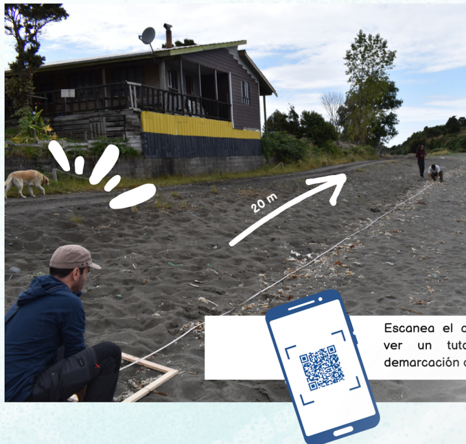
Figura 3. Demarcación del transecto y ubicación del punto de muestreo a 20 m.
