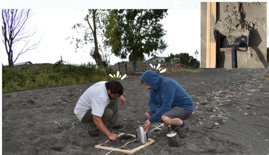
Figura 5. Extracción de 1 cm de arena con la pala metálica en el cuadrante escogido al azar.
